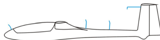
Miejsca montażu dajników energii całkowitej
